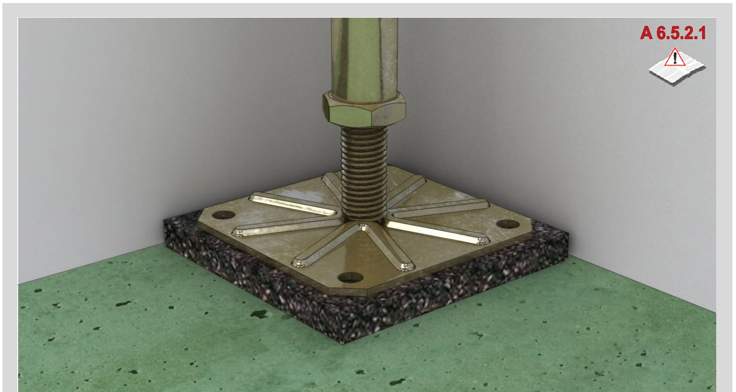
Иллюстрация 12 Монтаж звукопоглощающей подкладки
